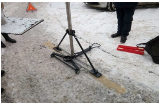
Рис. 1. Порядок установки прибора ППК МАДИ
